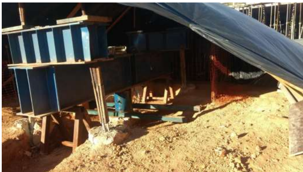
Figura 21 - Sistema de reação e dispositivo de aplicação de carga
