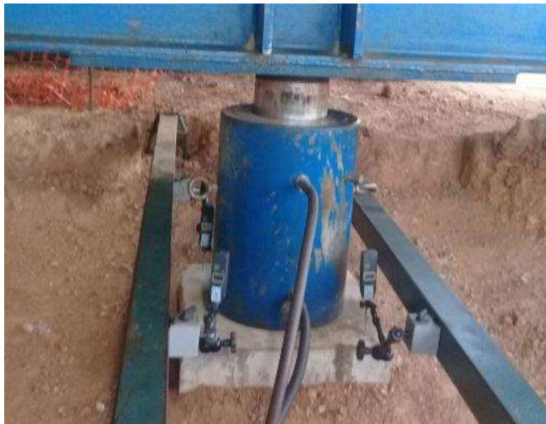
Figura 23 - Extensômetros fixados em duas vigas de referência metálicas.
