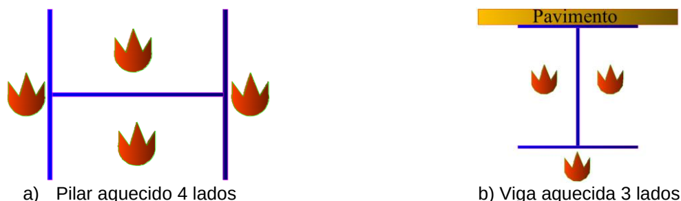
Figura 11 – Exposição das seções ao incêndio
