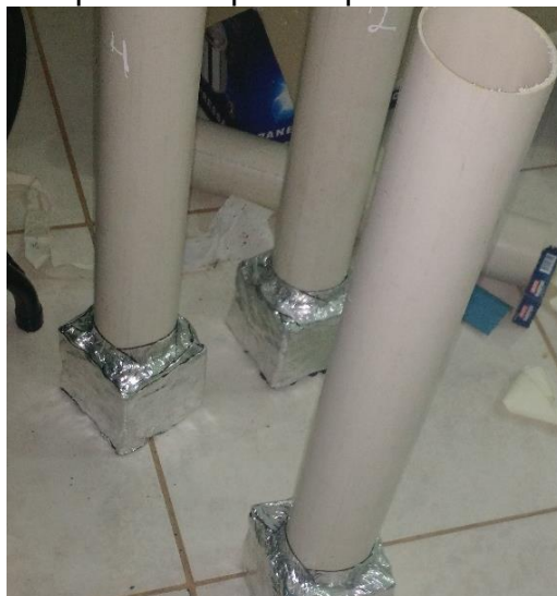
Figura 20 – Corpos de prova adaptados para o ensaio de permeabilidade.
