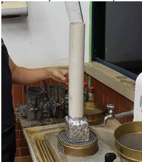
Figura 22 – Realização do ensaio de permeabilidade.
