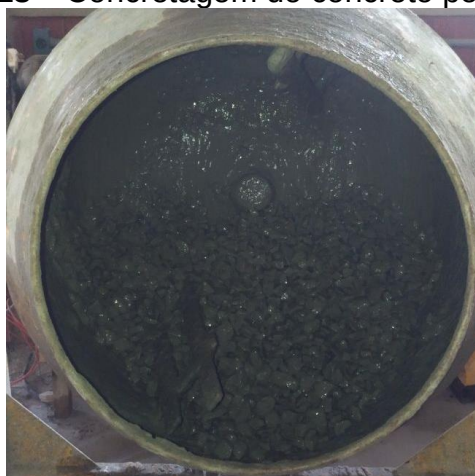
Figura 13 – Concretagem do concreto permeável.
