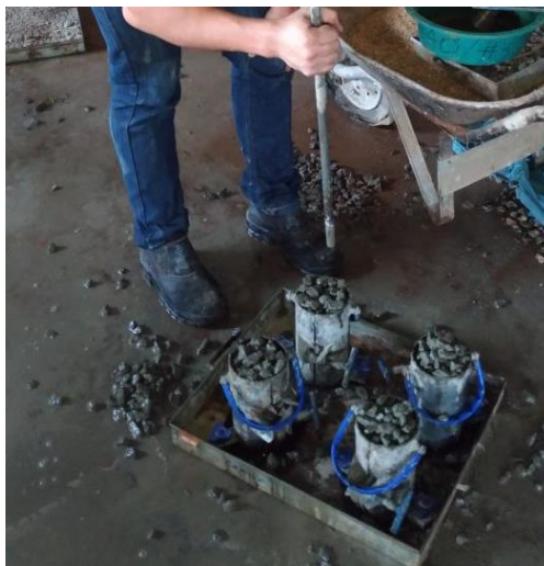
Figura 15 – Adensamento manual do concreto permeável.
