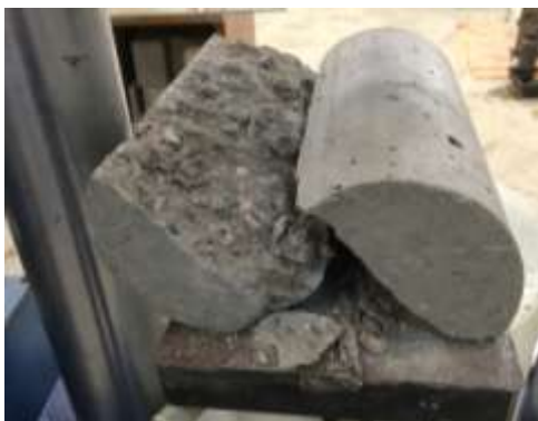
Figura 12: Corpo de prova após ensaio de tração por compressão diametral.
