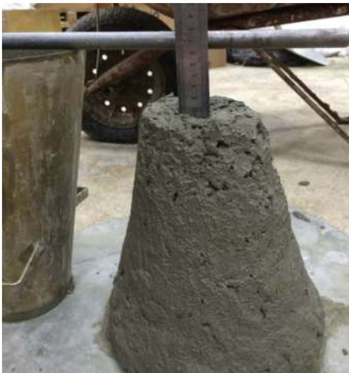
Figura 8: Slump Teste do traço com adição de 20% de pó de quartzo.
