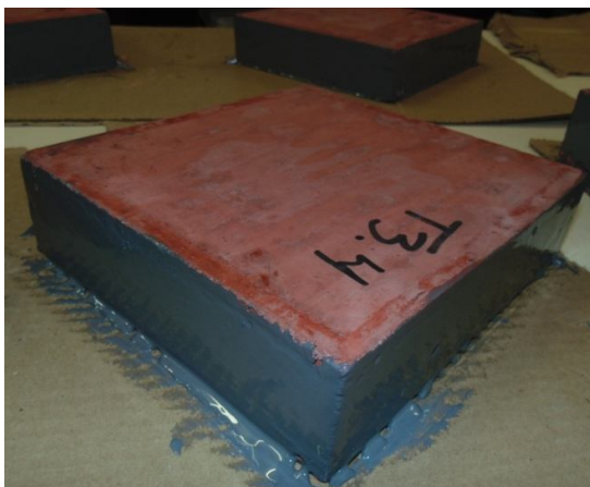
Figura 6: Aplicação de adesivo epóxi no corpo de prova para orientar o fluxo da solução
