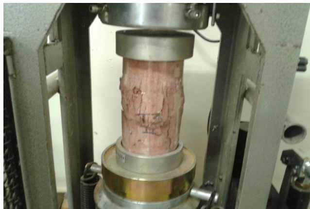
Figura 15: Determinação da resistência à compressão
