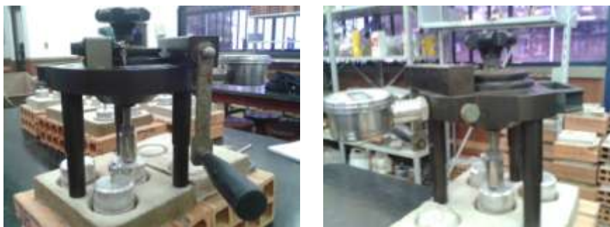
Figura 12 – Ensaio de arrancamento do revestimento Fonte: Elaboradas pelos autores
