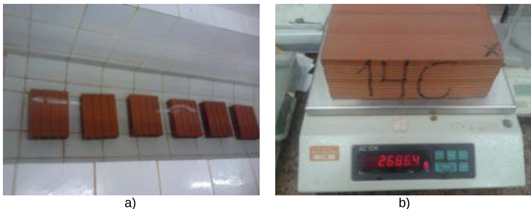
a) b) Figura 7 – Ensaio de Absorção de Água a) Saturação dos blocos cerâmicos e (b) Aferição da massa úmida do bloco Fonte: Elaboradas pelos autores
