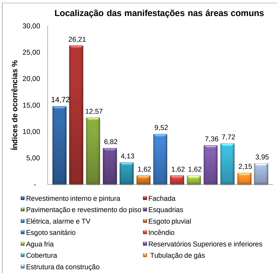
Figura 19: Principais manifestações patológicas em partes dos residenciais nas áreas comuns
