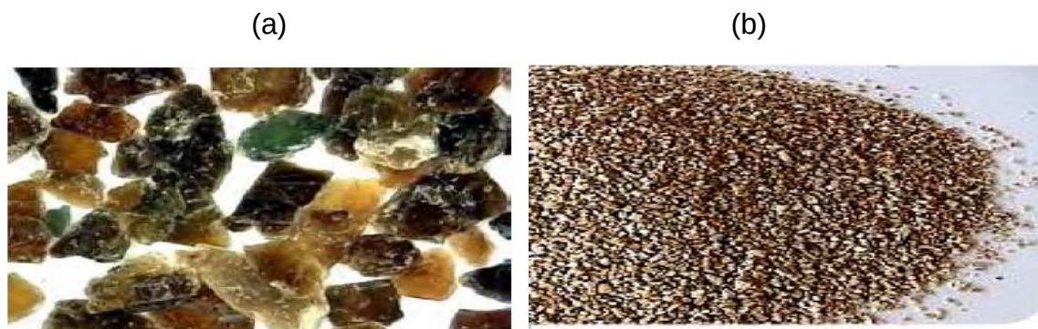
Figura 7 - Amostras de vermiculita: (a) Vermiculita natural (b) Vermiculita expandida (UGARTE et al., 2005)
