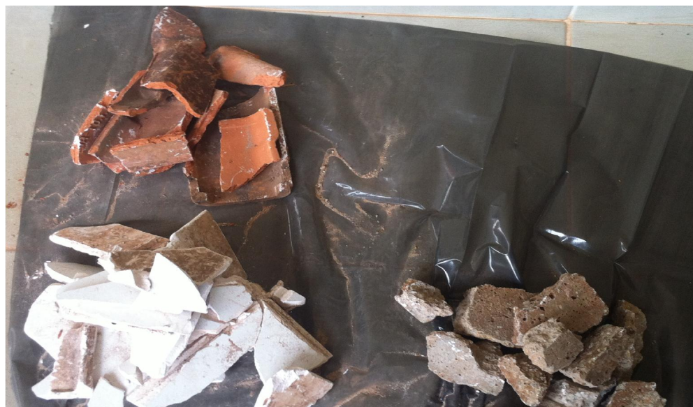
Figura 6: Separação dos componentes dos resíduos da construção e demolição. Fonte: Autores.
