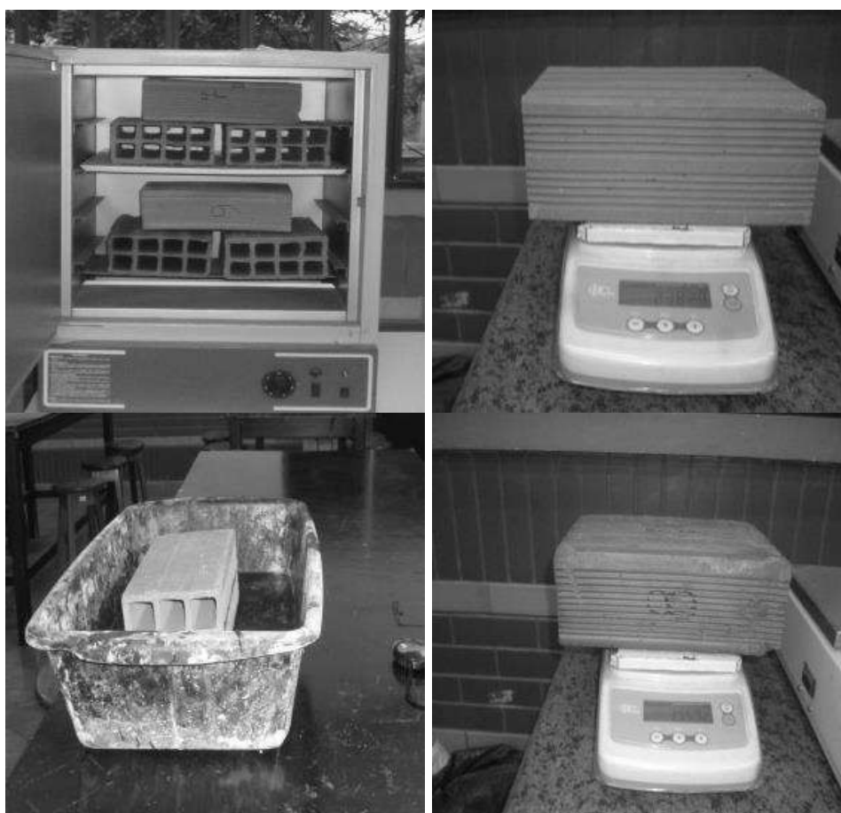
Figura 7: Ensaio para determinação do índice de absorção de água inicial
