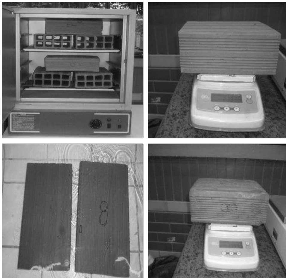
Figura 6: Ensaio para determinação do índice de absorção de água
