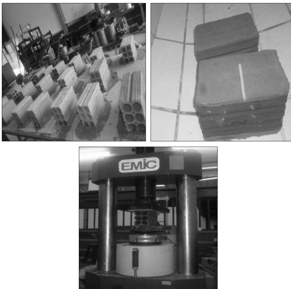
Figura 8: Ensaio para determinação da resistência à compressão
