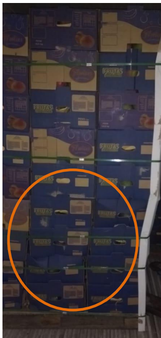
Figura 10 - Empilhamento inadequado das caixas de papelão
