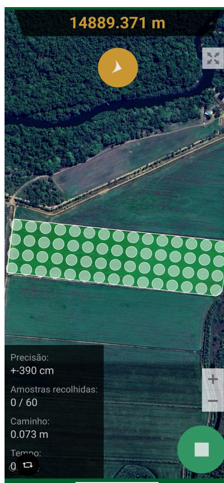
Figura 2 – Grade regular aleatorizada com 60 pontos no aplicativo Amostragem de solos.
