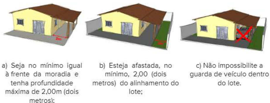
Figura 2 – Regulamentos para construção de varanda residencial.
