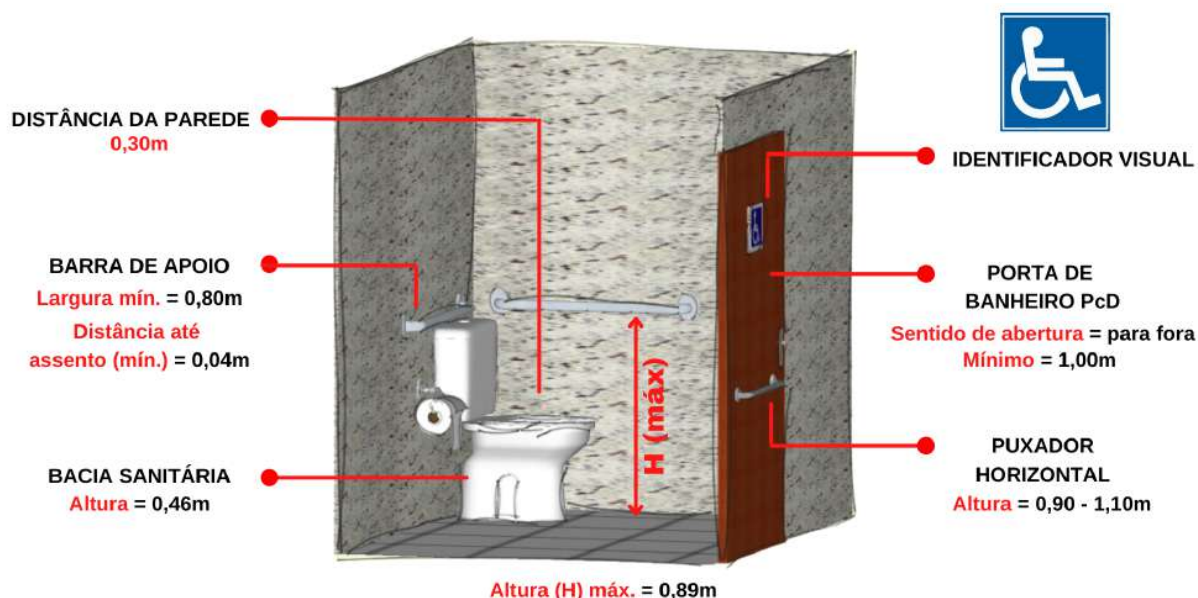
Figura 10 – Elementos e dimensões de um banheiro PcD
